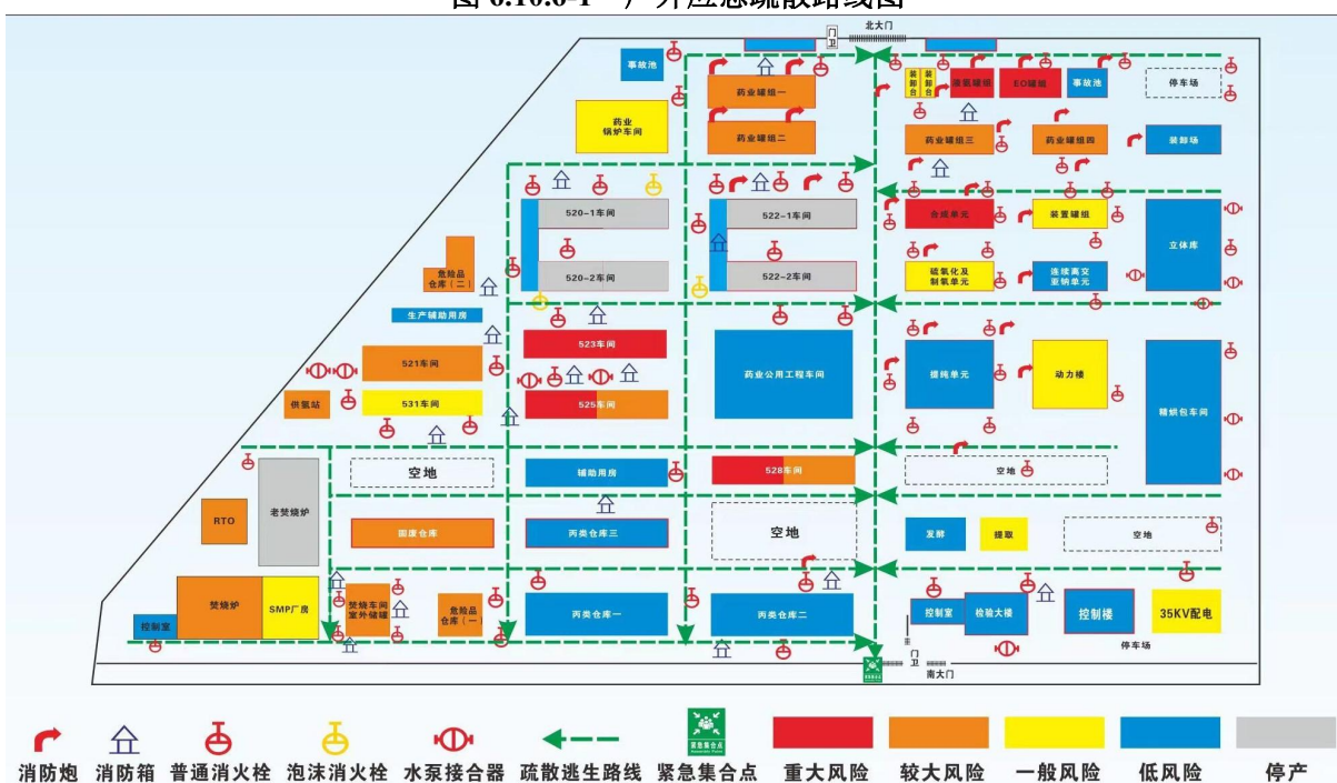
图 6.10.6-2 厂内应急疏散路线图
